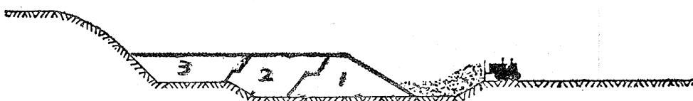
圖五十五(B) 斜坡法之「小格」鋪設法之二
